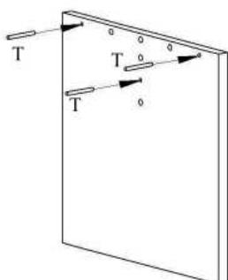
4. Složte všechny díly do sebe a pomocí excentrů je dotáhněte ve směru šipky pomocí imbus klíče, nakonec nasaděte krytky
