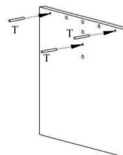
4. Složte všechny díly do sebe a pomocí excentrů je dotáhněte ve směru šipky pomocí imbus klíče, nakonec nasaděte krytky
