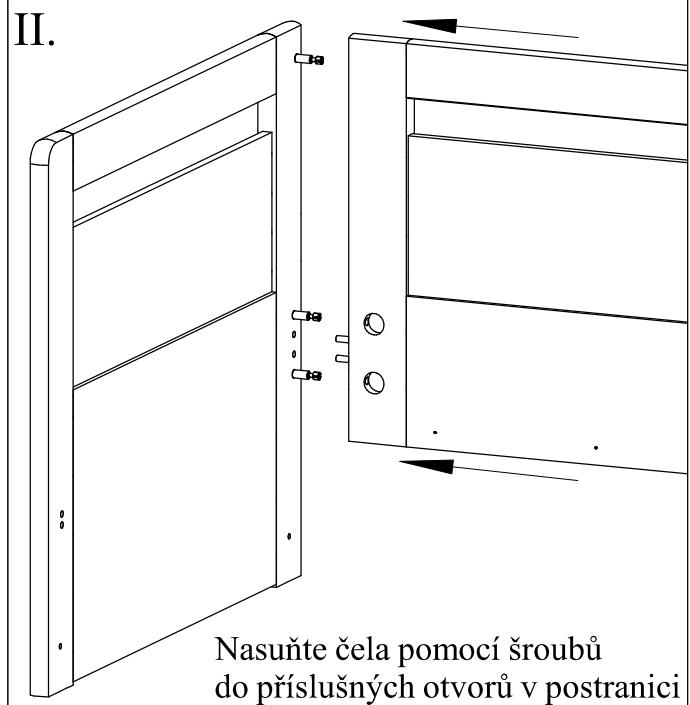
Nasuňte čela pomocí šroubů
