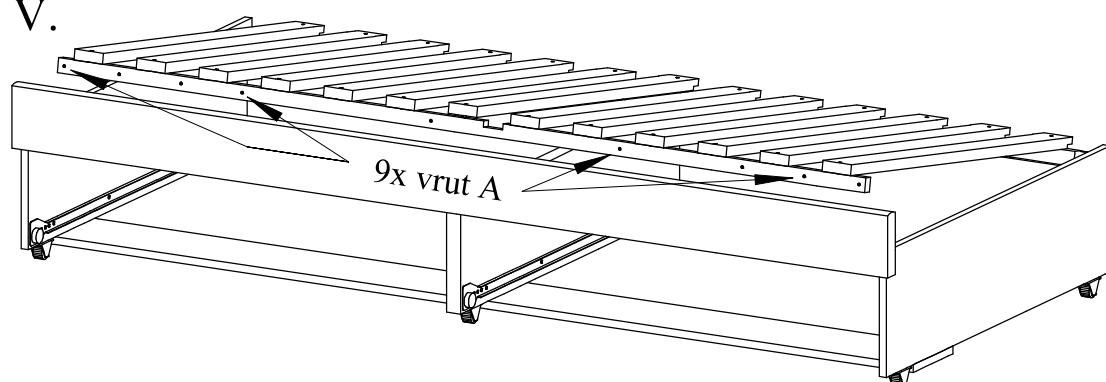
Vložte vruty (A) do předvrtaných otvorů v přední liště roštů a přišroubujte rošt k čelu boxu, ve kterém jsou také předvrtané otvory.
